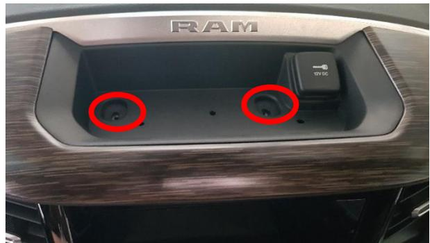
4. Abdeckung vom Navigationsgerät entfernen
